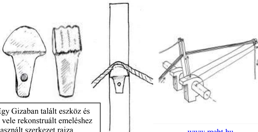
Martin Isler emelővel történő piramis építési modellje
